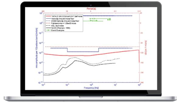
Diagrama del rango de funcionamiento de la amplitud en unidades de aceleración; sensor de aceleración de movimiento fuerte "Clase"
