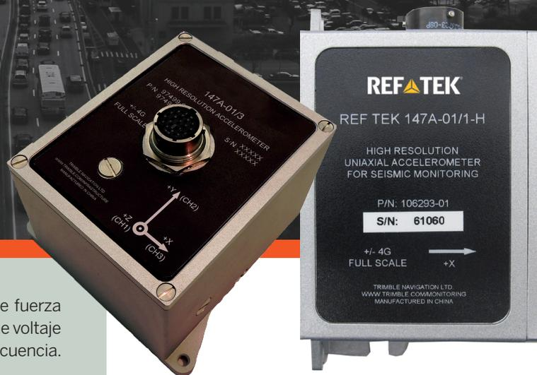
Los acelerómetros de alta resolución 147A son acelerómetros de fuerza balanceada que convierten las señales de aceleración en señales de voltaje para medir diversos movimientos de baja frecuencia y ultrabaja frecuencia. Pueden ser triaxiales o uniaxiales.
